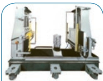
Inspection par tomographie à rayons X de cylindre de moteur automobile
