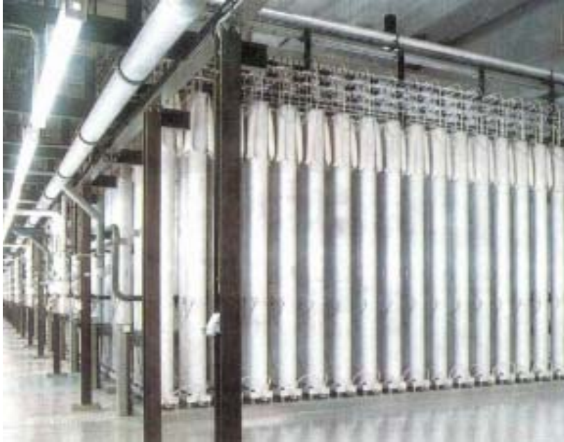
Cascade de centrifugeuses URENCO
